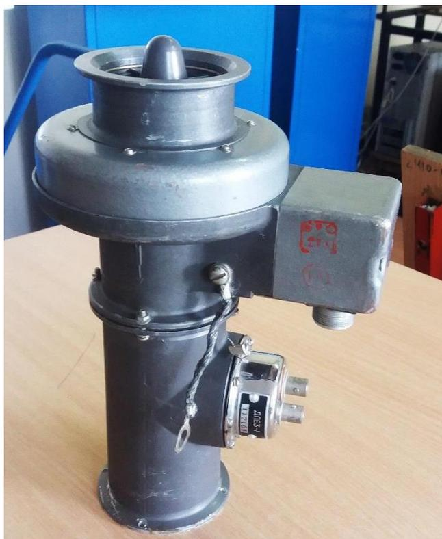
Рисунок 3.7 - Турбинный датчик расхода с плотномером жидкости емкостного типа
