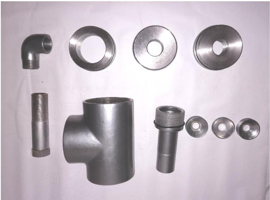
Рисунок 3.35 – Смесительная камера и сменные элементы СН
