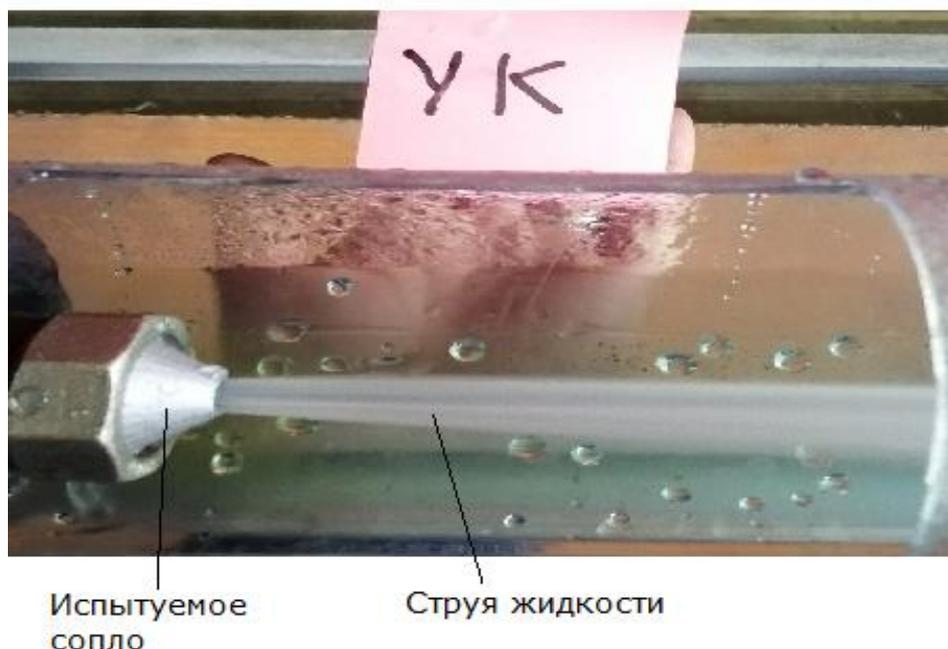
Рисунок 3.19 – Характерная форма высокоскоростной струи жидкости из испытываемого сопла
