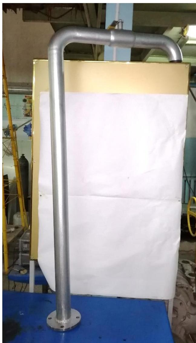
Рисунок 3.37 – Угловой патрубок отвода жидкости в напорную емкость
