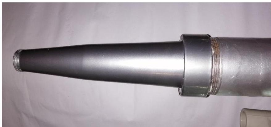
Рисунок 3.36 – Диффузор
