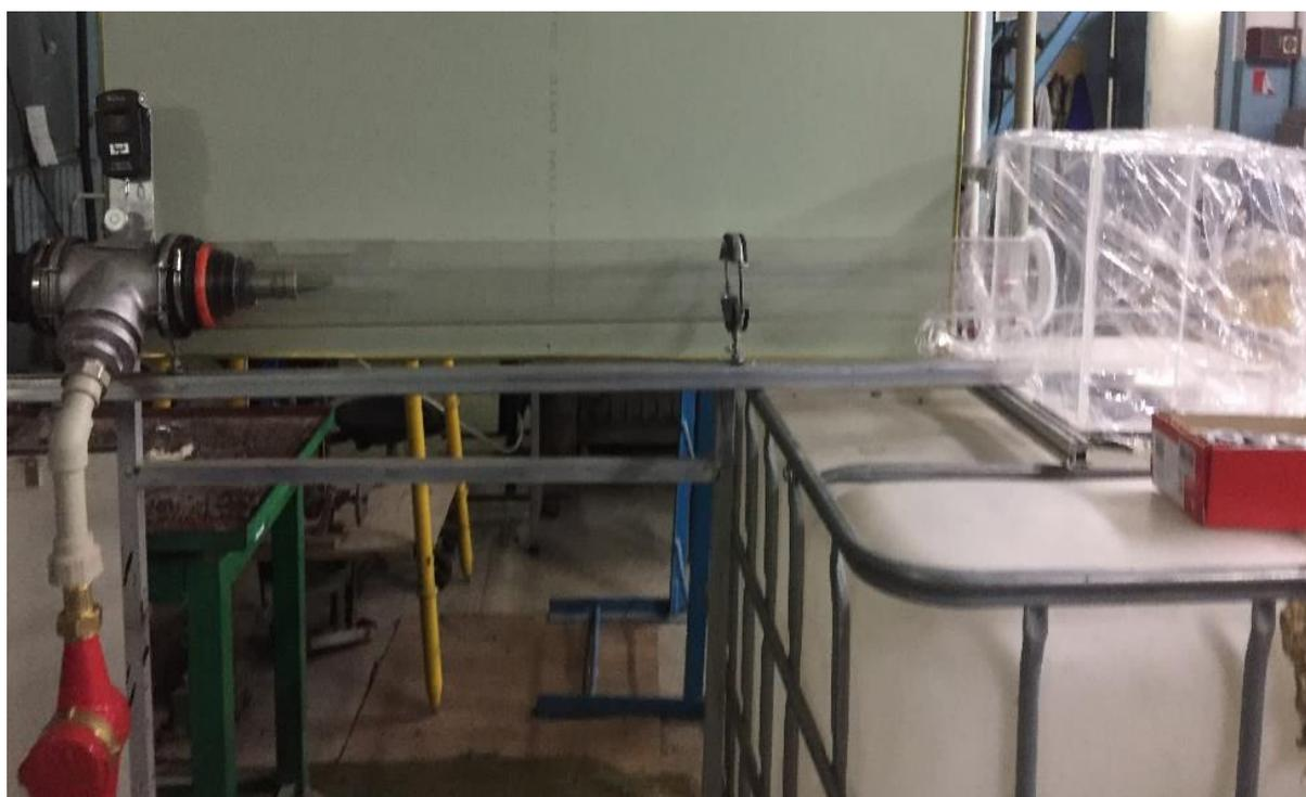
1 – измерительная головка; 2 – прозрачная труба; 3 – приемная камера;
