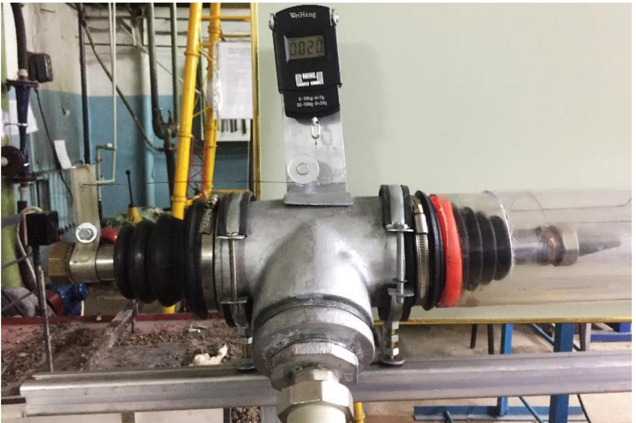
1 – тройник; 2 – гофра; 3 – напорная труба; 4 – заглушка с кронштейном; 5 – накидная гайка; 6 – сопло; 7 – кронштейн; 8 – силоизмеритель; 9 – трос
